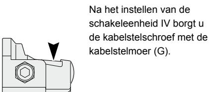
Na het instellen van de schakeleenheid IV borgt u de kabelstelschroef met de kabelstelmoer (G).
