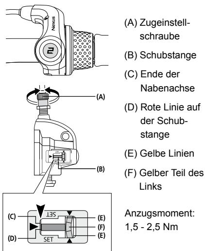
Schalten Sie den REVOSHIFT Hebel auf 2. Drehen Sie dann die Zugeinstellschraube (A), um die rote Linie (D) auf der Schubstange am Ende (C) der Nabenschale auszurichten.
