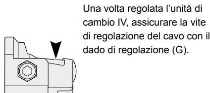
Una volta regolata l'unità di cambio IV, assicurare la vite di regolazione del cavo con il dado di regolazione (G).
